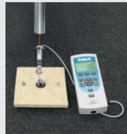
Verifica della resistenza degli elementi di fissaggio
