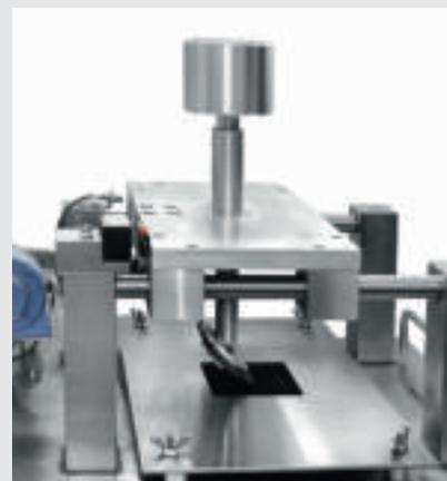
Dispositivo per "heel test"
