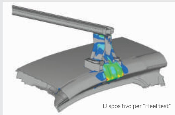
Dispositivo per "Heel test"
