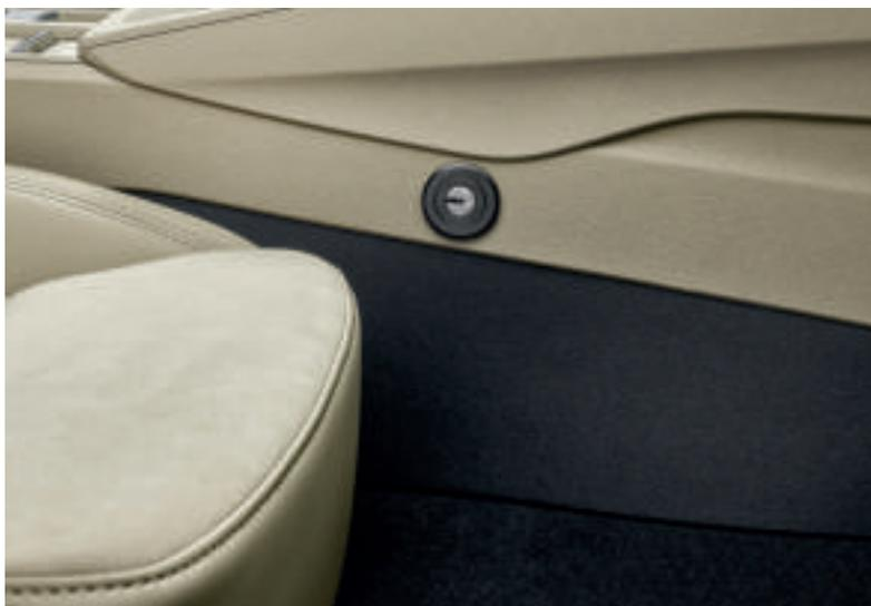
**Sistema di bloccaggio meccanico della trasmissione\***
