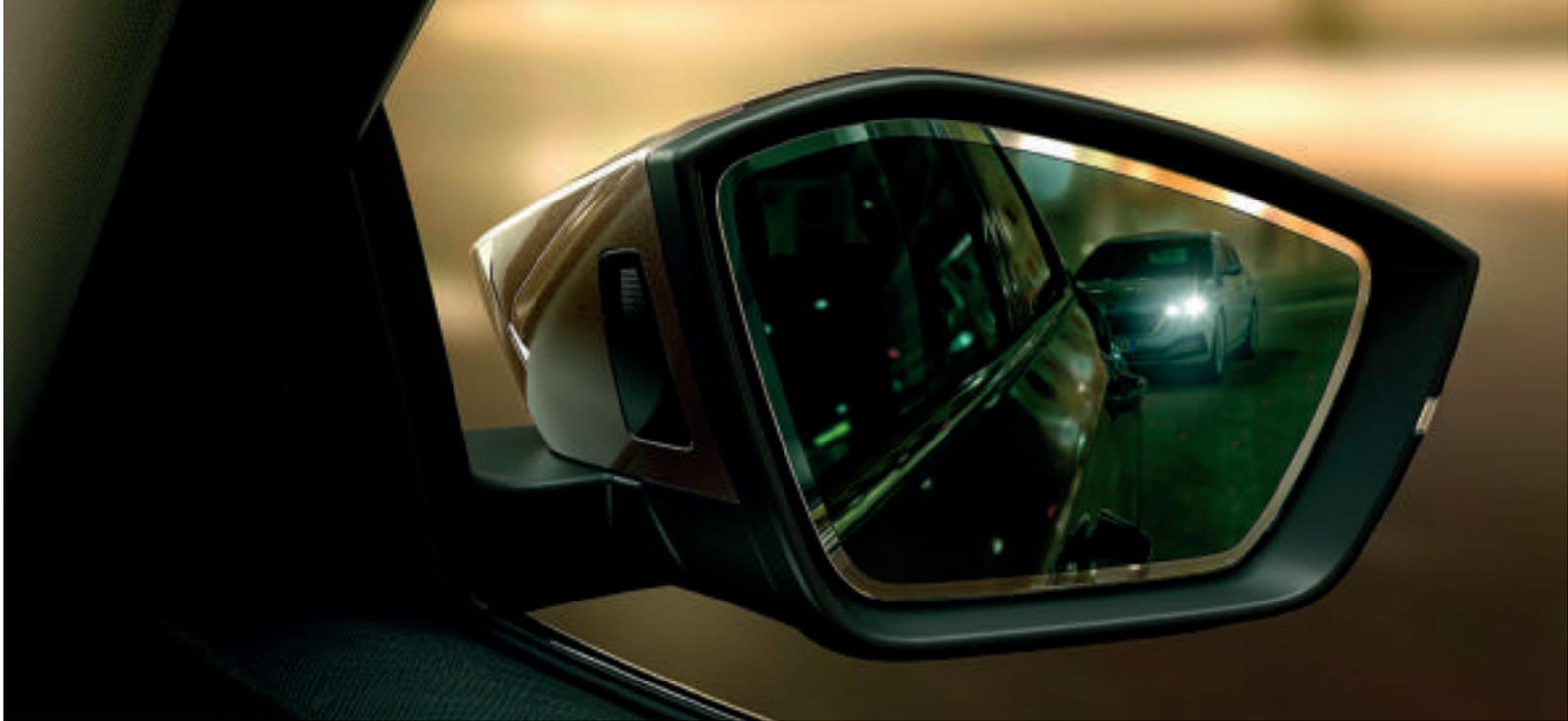
**Specchietto retrovisore esterno del passeggero con oscuramento automatico**
