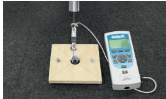
Verifica della resistenza degli elementi di fissaggio
